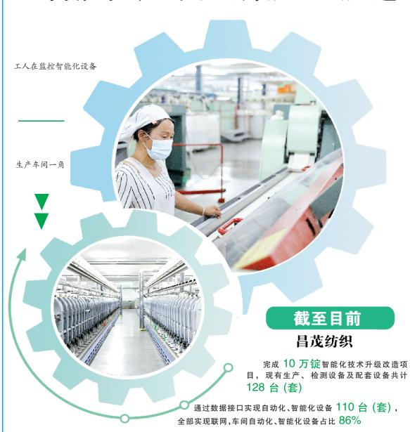
(上接第一版)全部实现联网,车间自动 化、智能化设备占比86%,自动化、智能 化设备联网率 100%,车间智能化设备的 应用及联网率达到行业领先水平,实现 从络筒机自动取纱、输送、品种识别、机 器人卸纱、堆垛、机械手拆垛、配重筛选、 自动套袋,整个流程可无人直接参与。
